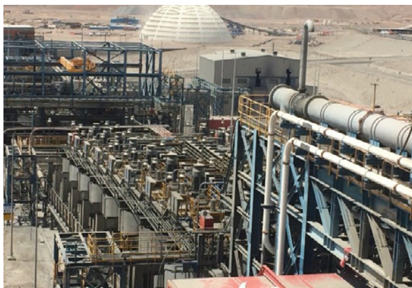
Flotationszellen als Vorstufe der Kupfergewinnung in Chile.
